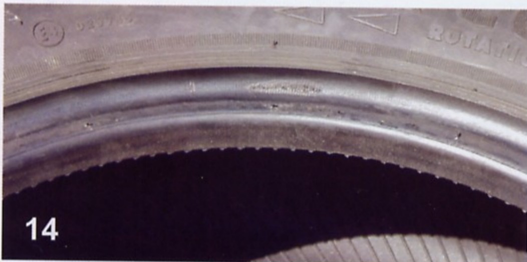
14 Usure au portage prononcée, suite à un roulage en sous gonflage ou en surcharge
